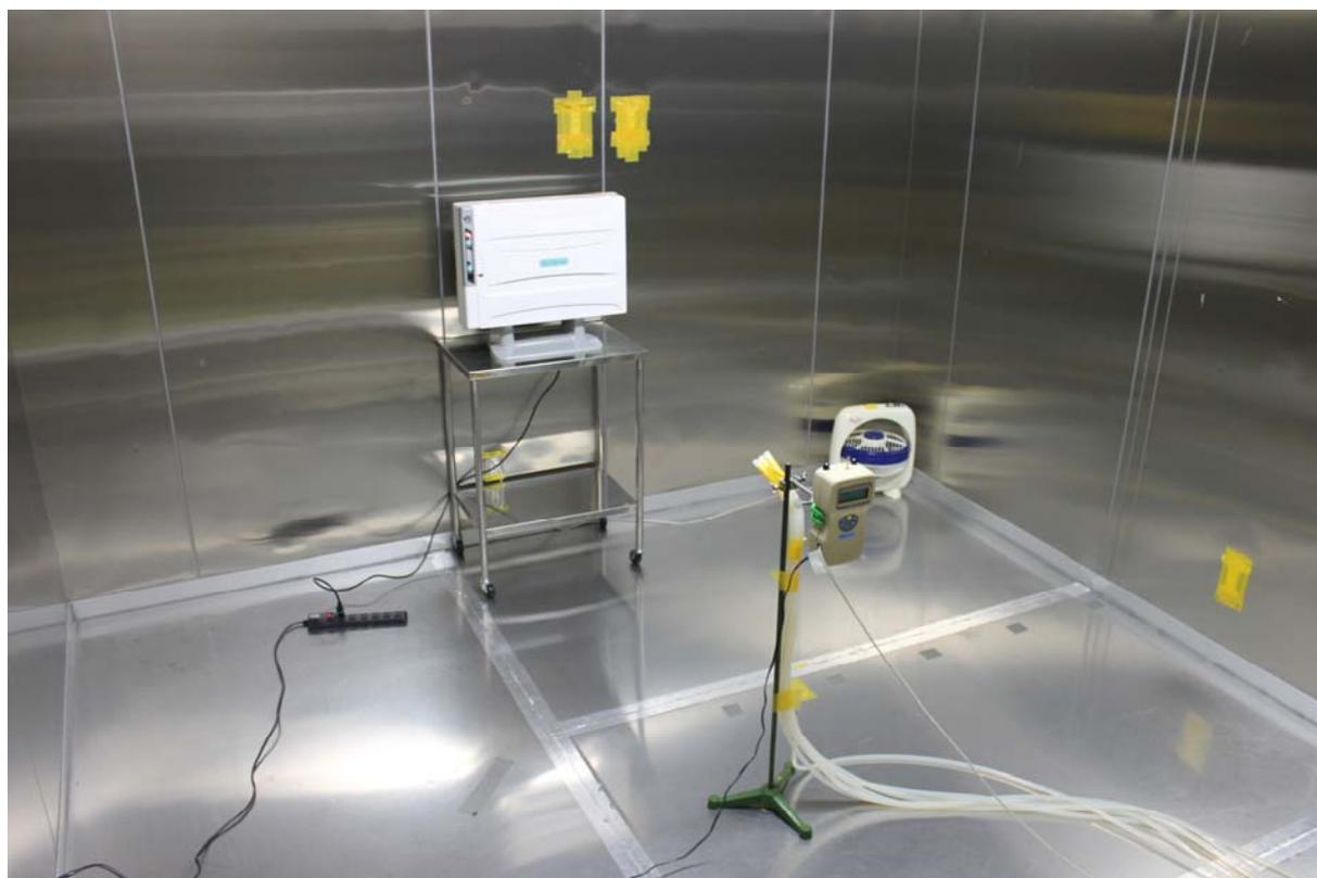
写真 2. 25 m<sup>3</sup> 試験チャンバーの様子
